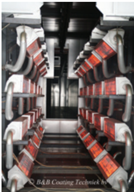
Inloop poedermoffeloven met katalytische IR-stralers.
