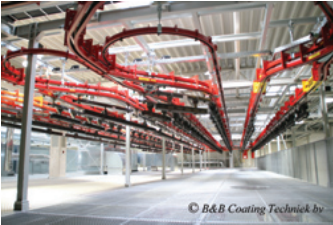
De sorteerbuffers op de eerste etage. Duidelijk zijn de verschillende lengtes van de traversen zichtbaar.
