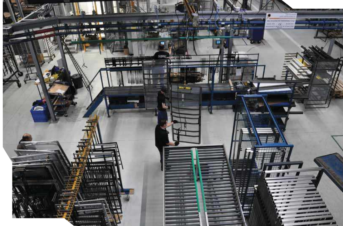
Het ophangen en inscannen van de te lakken producten.
