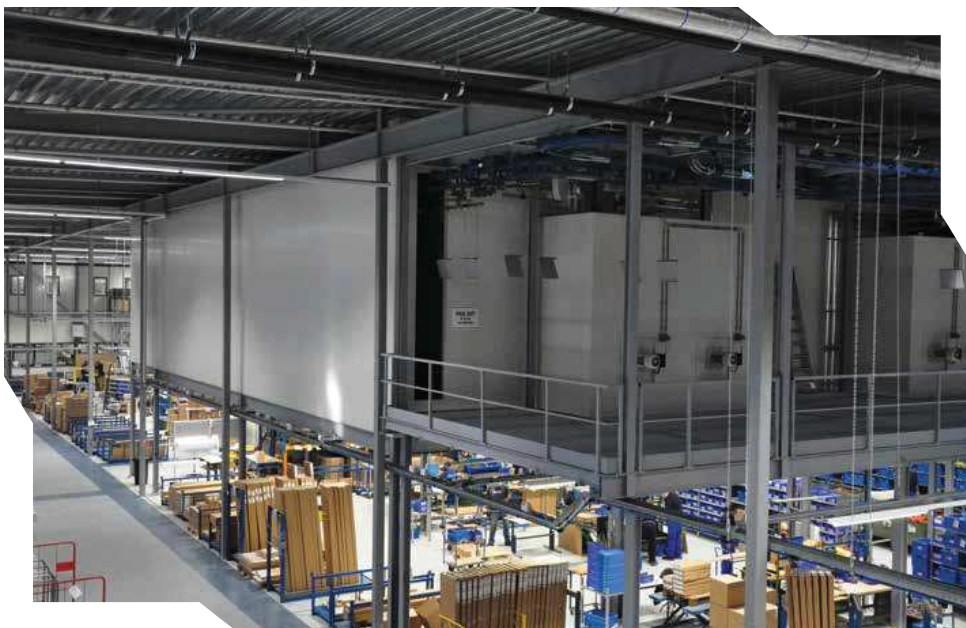
Het hoog geplaatste ovenblok (combi van droog en moffeloven).
