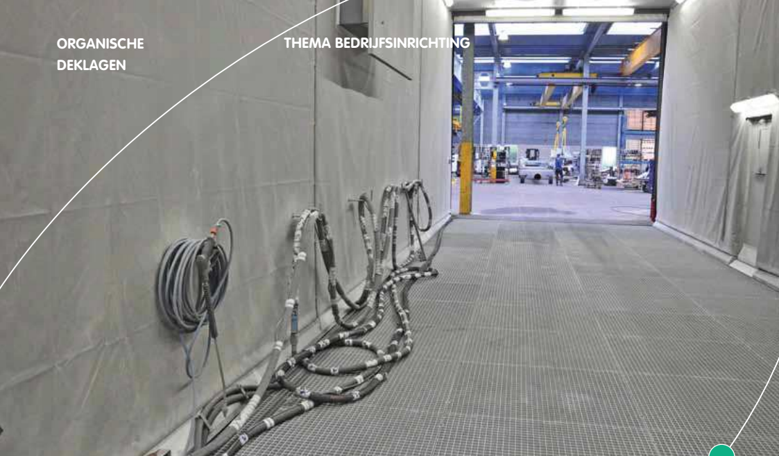
Erg lange straalhal waar constructiestaal tot 15,5 meter lengte behandeld kan worden
